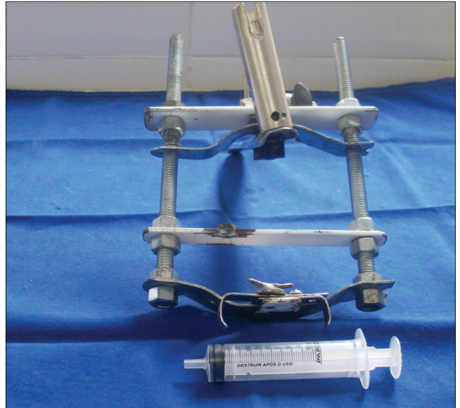
Figura 1. Abridor de boca especialmente desenvolvido para laringoscopia de suínos (Pontes et al., 2007)
