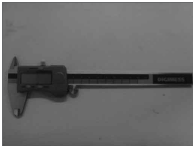
Figura 1. Paquímetro Digital Digimess Pró-Fono
