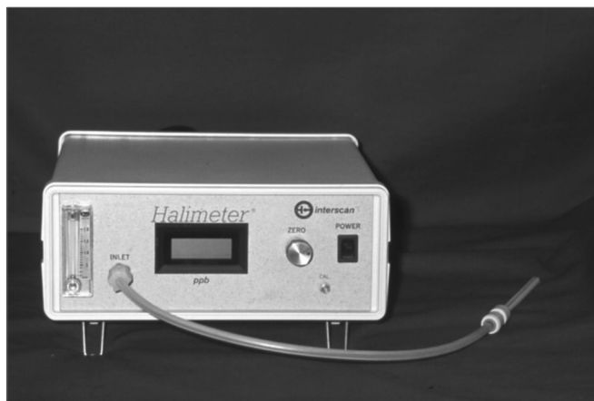
Figura 1. Halímetro: medida objetiva dos compostos sulfurados voláteis.
