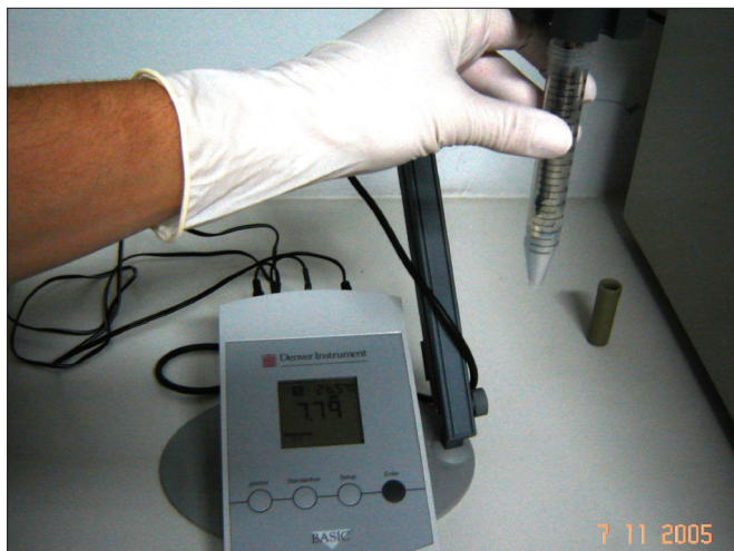
Figura 1. Tubo de ensaio de Falcon graduado contendo o sobrenadante de saliva. Demonstração do método de mensuração digital do pH salivar.
